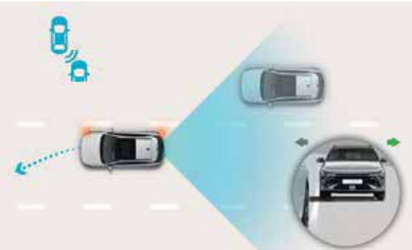
Blind-spot View Monitor (BVM). Désormais, vous pouvez voir les vues latérales arrière gauche et droite du KONA dans le combiné numérique. Les caméras sont activées par le clignotant lors des changements de voie.
