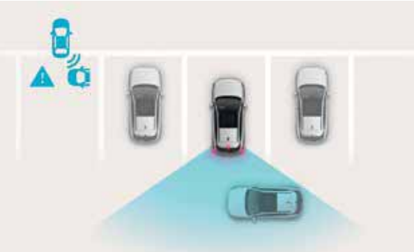
Rear Cross-Traffic Collision-Avoidance Assist (RCCA). Idéal pour les parkings. En situation de marche arrière dans des zones à faible visibilité, le système va non seulement vous avertir si des véhicules approchent depuis les côtés, mais il va aussi actionner automatiquement les freins si nécessaire.
