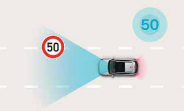
Intelligent Speed Limit Assist (ISLA). Cette fonction de conduite semi-autonome reconnaît les panneaux de signalisation et ajuste la vitesse en fonction de la limite de vitesse en vigueur (si activé).
