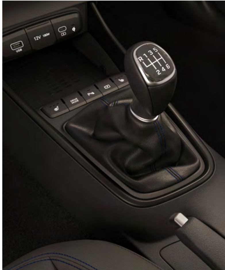
Transmisión manual de seis velocidades.
