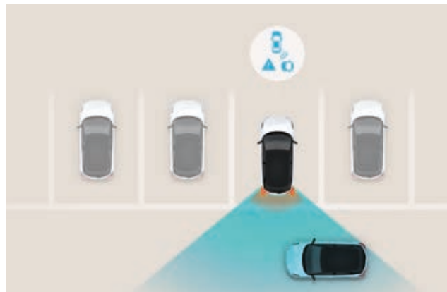
Alerta de aproximación de tráfico trasero activo (RCCA). Al dar marcha atrás en zonas de poca visibilidad, el sistema te avisa si se aproximan vehículos por el lateral y activa los frenos de forma automática si fuera necesario.
