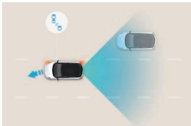
**Sistema de detección de ángulo muerto (BCA).** Mediante dos sensores situados en la parte inferior del parachoques trasero, el sistema te avisa de los vehículos que se acercan por la zona del ángulo muerto. Si activas el intermitente en esa dirección, el sistema emite una señal acústica y activa el freno para evitar la colisión en caso necesario.
