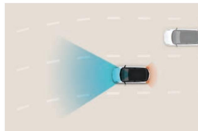
**Control de crucero inteligente basado en navegación (NSCC).** Utiliza el sistema de navegación de última generación para anticiparse a las curvas y rectas de la autopista y ajusta automáticamente la velocidad para una conducción más segura.
