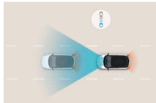
**Sistema de asistencia a la frenada de emergencia (FCA).** La carretera se monitoriza en todo momento gracias a un radar y una cámara en la parte frontal del vehículo; el sistema FCA te avisa y activa automáticamente el freno si detecta una colisión inminente con el coche que circula delante o peatones o ciclistas cruzando la vía.
