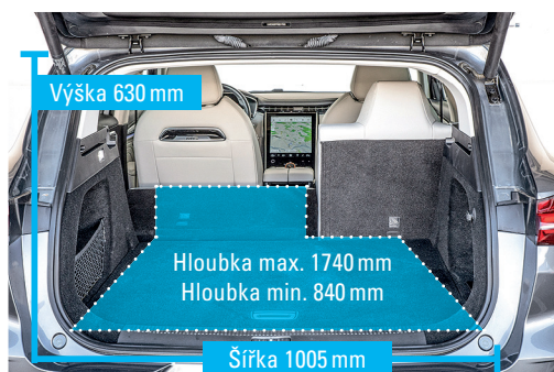
MG: Marvel R je nejméně prostorným vozem ve srovnání, což dokládá i menší zavazadelník (357-1396 l), zklame i zatížení 397 kg
