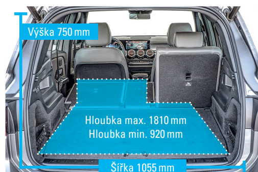
Mercedes: Díky rozložení sklopných opěradel získáte malý otvor uprostřed. Zavazadelník pobere 495-1710 l, celkem uvezete 473 kg.
