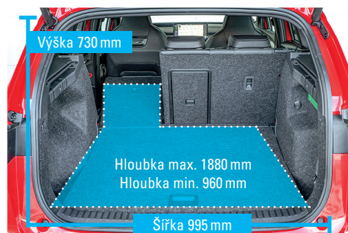
Škoda: Rodinný elektromobil s přepravní kapacitou 585 až 1710 litrů zároveň zvládne i nejvyšší užitečné zatížení dosahující 532 kilogramů
