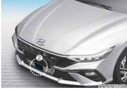
[1]: Ön görüş kamerası, [2]: Ön radar
