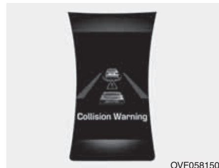
Collision Warning (Second warning) (Varování před kolizí (druhá výstraha)) Toto varovné hlášení se zobrazí na displeji LCD a zazní varovný tón. Navíc může systém zasáhnout do řízení motoru a tím pomoci vozidlo zpomalit. - Rychlost vozidla se může pomalu snižovat. - Systém FCA omezeným způsobem ovládá brzdy, aby preventivně snížil následky případné srážky.
