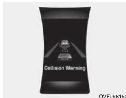
Collision Warning (First warning) (Varování před kolizí (první výstraha)) Toto varovné hlášení se zobrazí na displeji LCD a zazní varovný tón.
