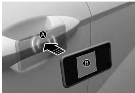
[A] Autentizační podložka v klice dveří [B] Anténa NFC
