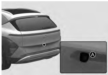
[A] Širokoúhlá zpětná kamera Umístění detekčního snímače je znázorněno na obrázku výše.
