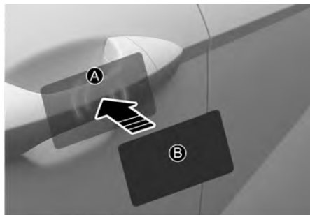
[A] Autentizační podložka v klince dveří [B] Anténa NFC kartového klíčku
