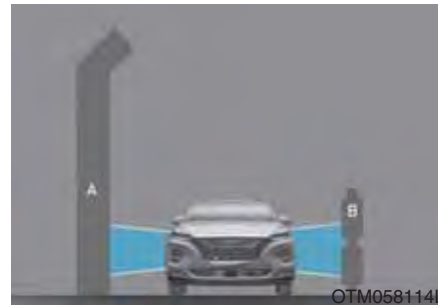
[A]: protihluková bariéra, [B]: svodidla
