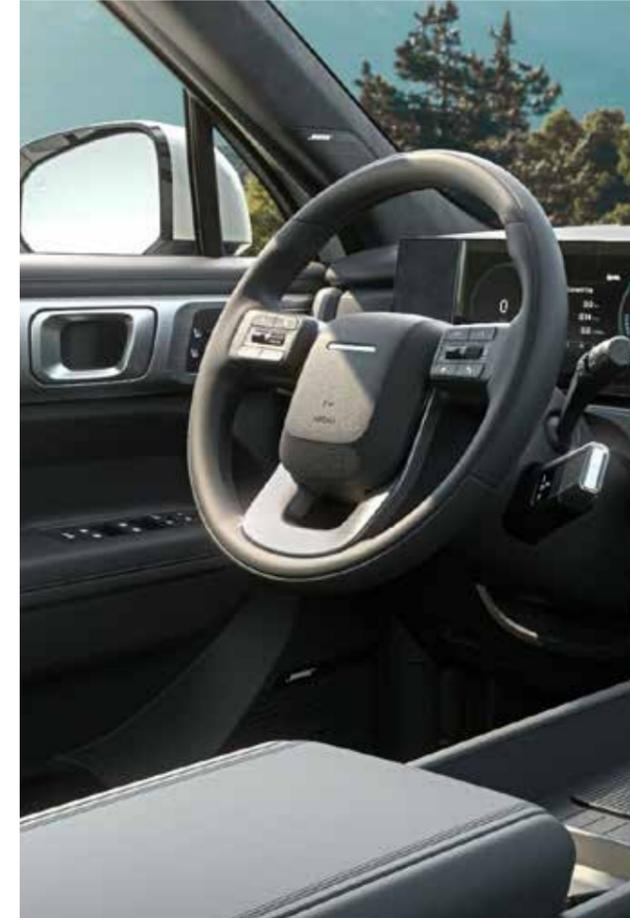
Volante riscaldato con regolazione elettrica
