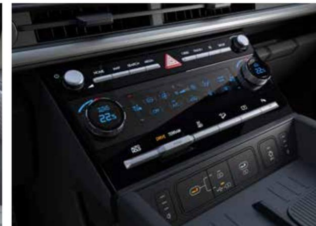
Controllo automatico della temperatura (bizona)
