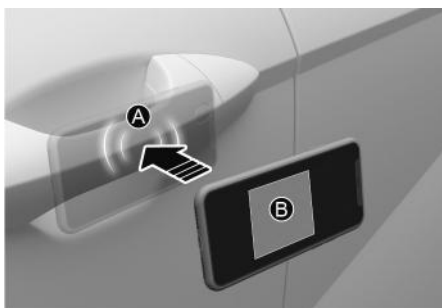
[A] Autentizační podložka kliky dveří [B] Anténa NFC
