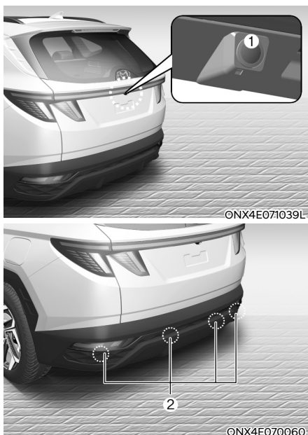
[1]: Širokouhlá zpětná kamera, [2]: Zadní ultrazvukové snímače.
