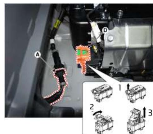
4-2 . In Notfallsituationen, in denen der Sicherheitsstecker nicht abgezogen werden kann, durchtrennen Sie die Sicherheitsleitung, die entweder vom Kofferraum aus oder am Brennstoffzellenmodul im Motorraum zugänglich ist.
