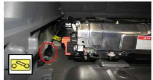
4. Service Disconnect Stecker wie dargestellt entfernen (isolierende Schutzhandschuhe bis 1000 V erforderlich).
