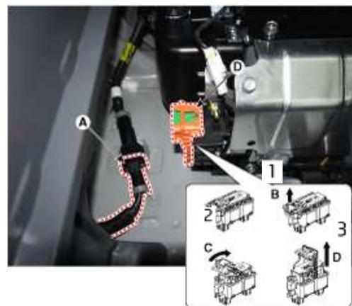
5-2 . In Notfallsituationen, in denen der Sicherheitsstecker nicht abgezogen werden kann, durchtrennen Sie die Sicherheitsleitung, die entweder vom Kofferraum aus oder am Brennstoffzellenmodul im Motorraum zugänglich ist.
