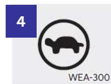
4 : Die Leistungsbegrenzungsanzeige ("Schildkröte", Power Down) weist auf eine Störung des Brennstoffzellenstacks hin. Sie leuchtet während der Fahrt auf, wenn aufgrund einer Fehlfunktion des Brennstoffzellenstacks die Fahrzeugleistung begrenzt ist.
