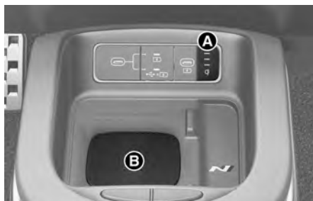
[A] Kontrolka [B] Nabíjecí podložka
