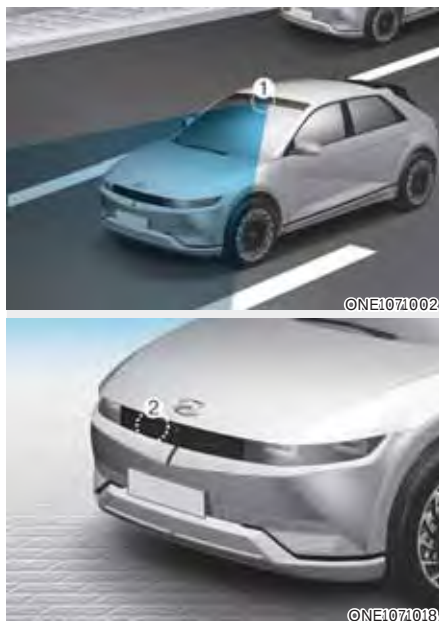
[1]: Přední kamera, [2]: Přední radar
