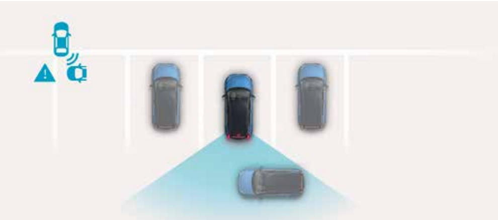
När du backar varnar Rear Cross-traffic Collision-avoidance Assist dig om fordon närmar sig från sidan. Systemet bromsar också automatiskt. ◊
