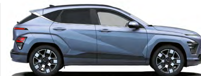
Długość całkowita 4355 Rozstaw osi 2660
