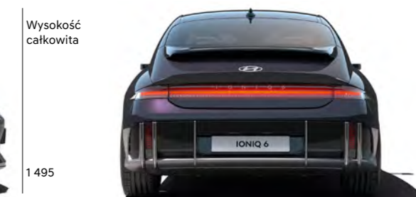
Wysokość całkowita 1495 Rozstaw kół 1639
