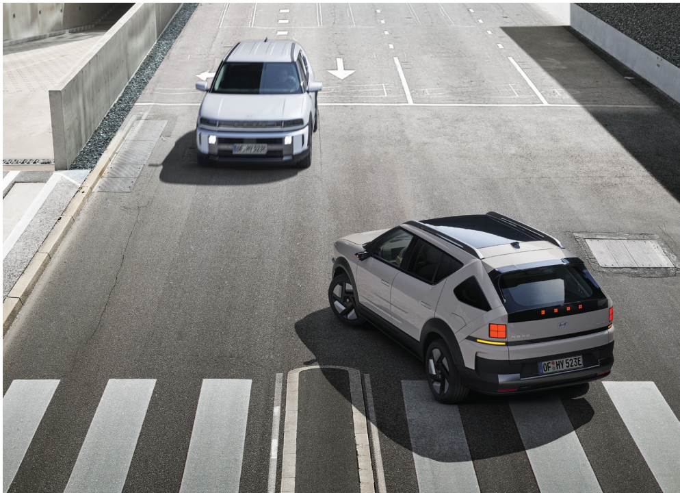
Asystent unikania kolizji czołowych (FCA 2): Ostrzega, gdy pojazd przed Tobą nagle zwalnia lub wykryje ryzyko kolizji z pojazdem, pieszym lub rowerzystą – może również automatycznie zahamować. 3
