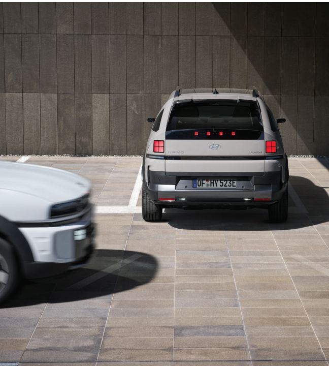
Asystent monitorowania ruchu poprzecznego u (RCCA): Podczas cofania z miejsc o ograniczonej widoczności system ostrzega o nadjeżdżających pojazdach z boku – i automatycznie hamuje. 3
