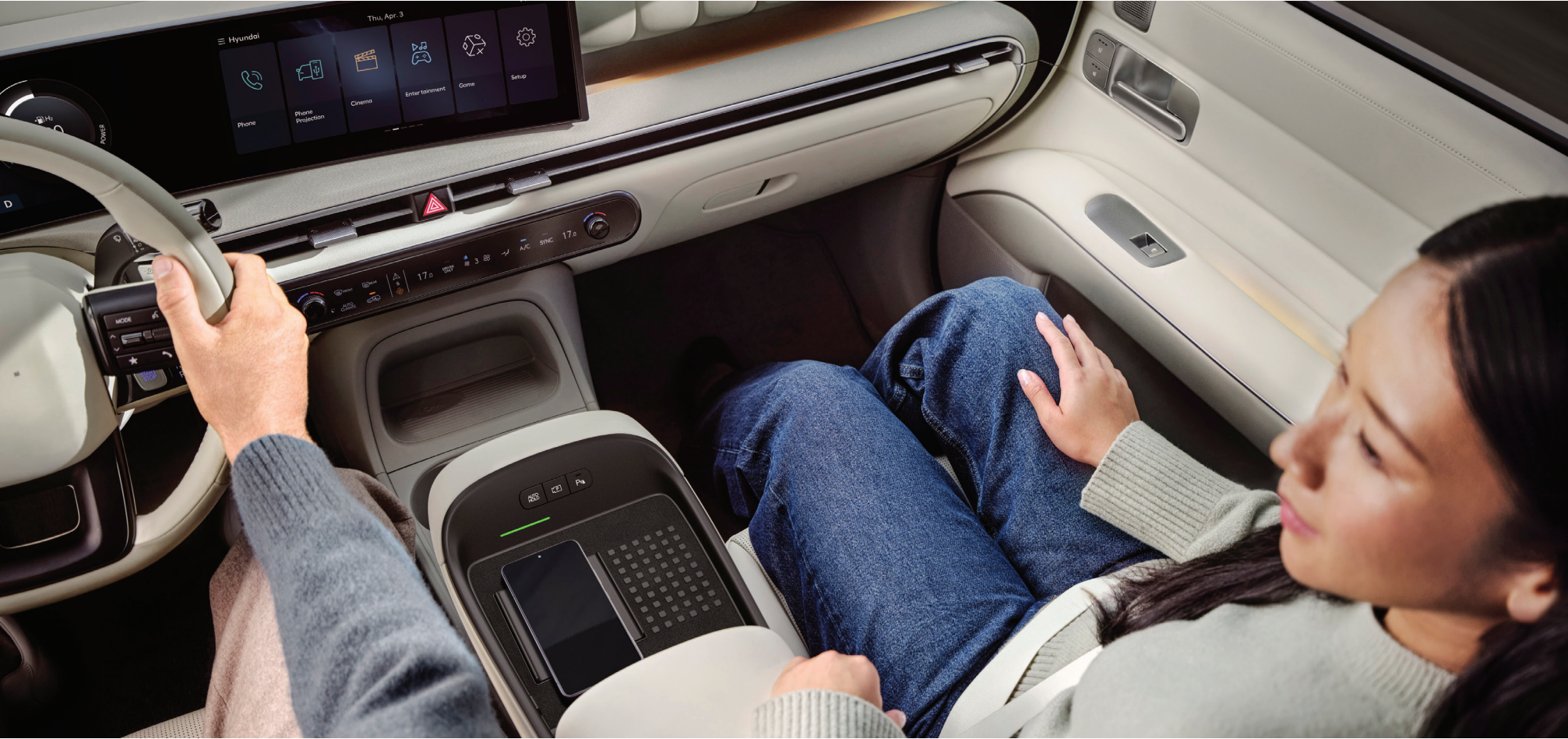
Bezprzewodowa ładowarka w konsoli środkowej umożliwia szybkie ładowanie smartfona. Układ o mocy 15W zawiera wentylator chłodzący zapobiegający przegrzaniu. Na pokładzie znajdują się również porty USB-C.
