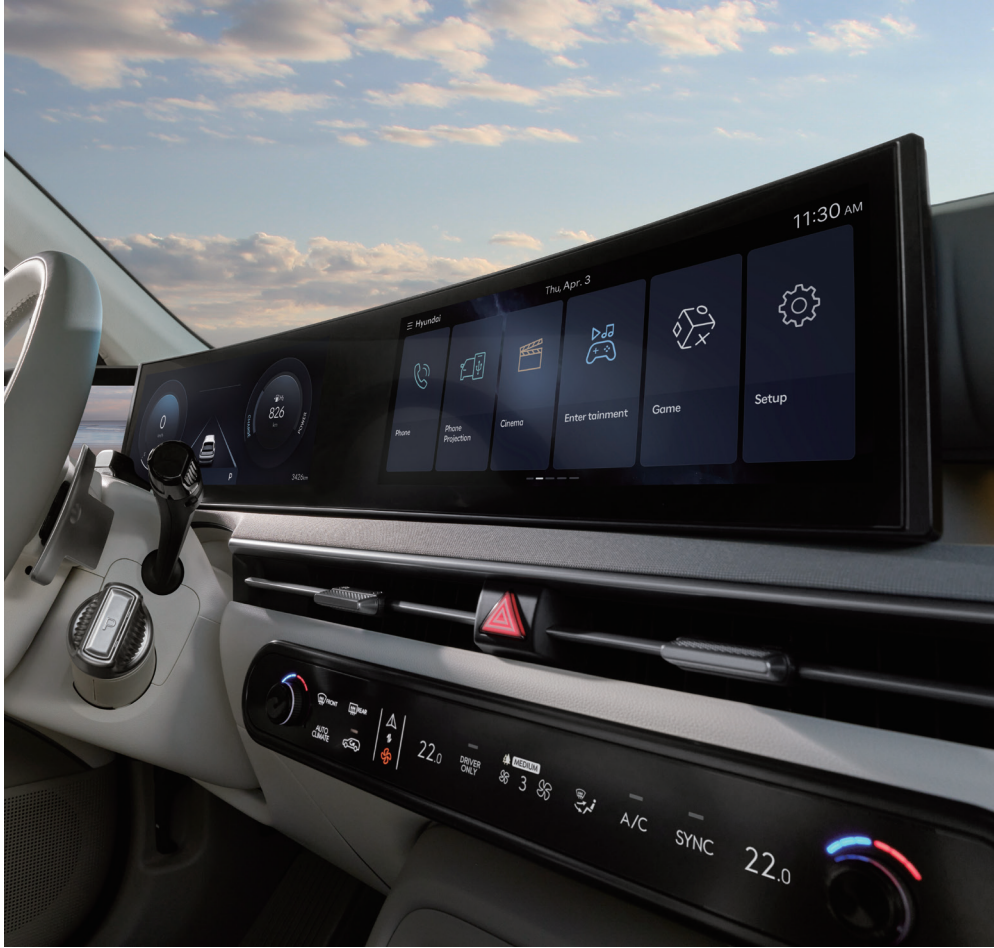
Panoramiczny zakrzywiony wyświetlacz łączy 12,3" zestaw wskaźników i 12,3" ekran systemu multimedialnego.
