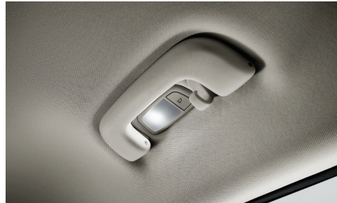
Wewnętrzne oświetlenie LED.
