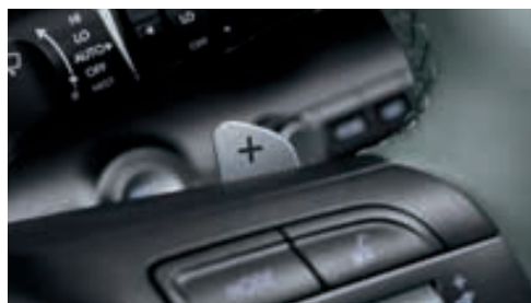
Pádkla pod volantem umožňující sekvenční řazení rychlostních stupňů – pro ICE / možnost nastavení rekuperačního brzdění – pouze pro HEV
