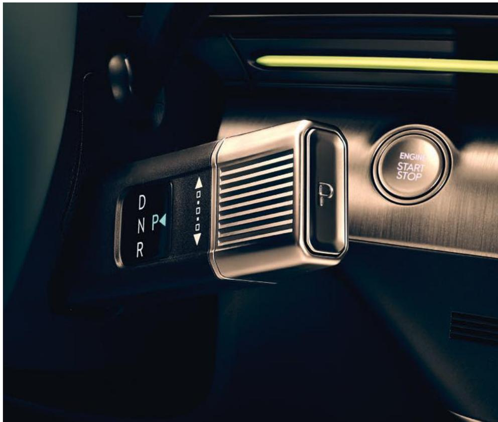
**Shift-by-wire sul piantone dello sterzo.**
