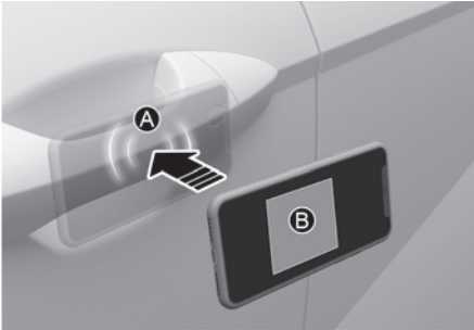
[A] Autentiseringspute for dørhåndtak [B] NFC-antenne
