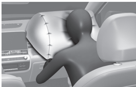
Frontkollisjonspute på passasjersiden (4)
