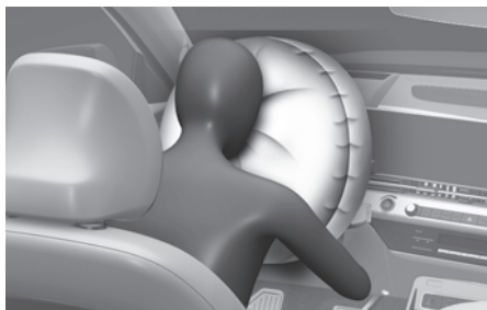
Frontkollisjonspute på passasjersiden (4)
