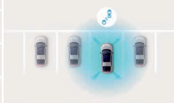
360° Çevre Görüş Kamera Sistemi (SVM). Dar otoparklar veya küçük yerlere girmek hiç sorun değil. IONIQ 6'daki çevre görüş ekranı, dar alanlarda manevra yapmayı kolay ve güvenli hâle getiriyor. Araçtaki dört adet kamera, çevrenizin 360° görünümünü sağlıyor.
