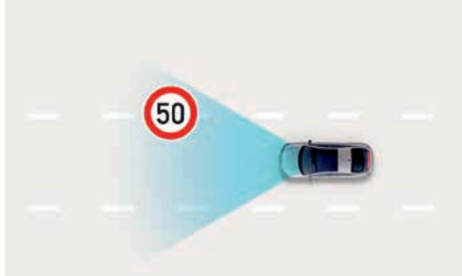
Akıllı Hız Limitleme & Tabela Okuma Asistanı (ISLA). Bu yarı otonom sürüş özelliği etkinleştirildiğinde yoldaki hız işaretlerini tanıyor ve araç hızını hız sınırına uyacak şekilde ayarlıyor.
