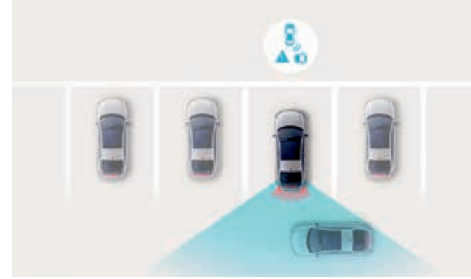
Arka Çapraz Çarpışma Uyarısı ve Asistanı (RCCA - W&A). Otoparklar için mükemmel. Görüş mesafesinin düşük olduğu alanlardan geri geri çıkarken sistem, sürücüyü sadece yandan yaklaşan araçlar konusunda uyararak kalmıyor, aynı zamanda otomatik olarak fren de uyguluyor.
