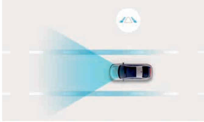
Şerit Takip Asistanı (LFA). Araçınızın şeridin merkezinde ve güvende olmasını sağlıyor. Etkinleştirildiğinde, otoyollarda ve şehir içi caddelerde 0 ile 185 km/s arasındaki hızlarda aracı şeridinin ortasında tutuyor.
