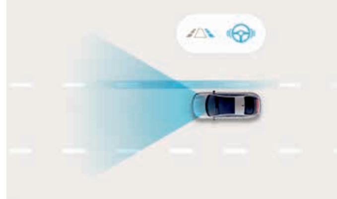
Şeritte Kalma Asistanı (LKA). Düz ve dar yollarda şeridinizde kalmanıza yardımcı oluyor. LKA, sinyal vermeden şeridinizden çıkmaya başladığınızda görsel ve işitsel uyarılar gönderiyor ve sizi geri yönlendirmek için zarif düzeltme hareketleriyle direksiyona desteği sağlıyor.
