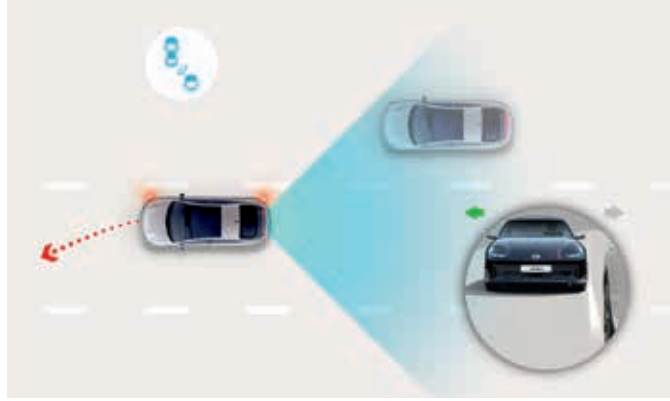
Kör Nokta Çarpışma Önleme Asistanı (BCA). Yoğun trafikte daha fazla güvenlik sağlayan BCA, kör noktanızda bir araç algılandığında ve şerit değiştirmeye başladığınızda sizi uyararak otomatik olarak sol veya sağ fren uygulayıp direksiyonu yönetiyor.
