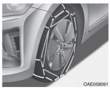
Ponieważ ścianki boczne opon radialnych są cieńsze, założenie niektórych rodzajów łańcuchów śniegowych może spowodować ich uszkodzenie. Z tego względu zaleca się korzystanie z opon zimowych zamiast łańcuchów śniegowych nie należy zakładać w pojazdach, które są wyposażone w felgi aluminiowe, ponieważ mogą one powodować uszkodzenia felg. Jeśli użycie łańcuchów śniegowych jest niezbędne, należy zastosować łańcuchy drutowe o grubości poniżej 12 mm.
