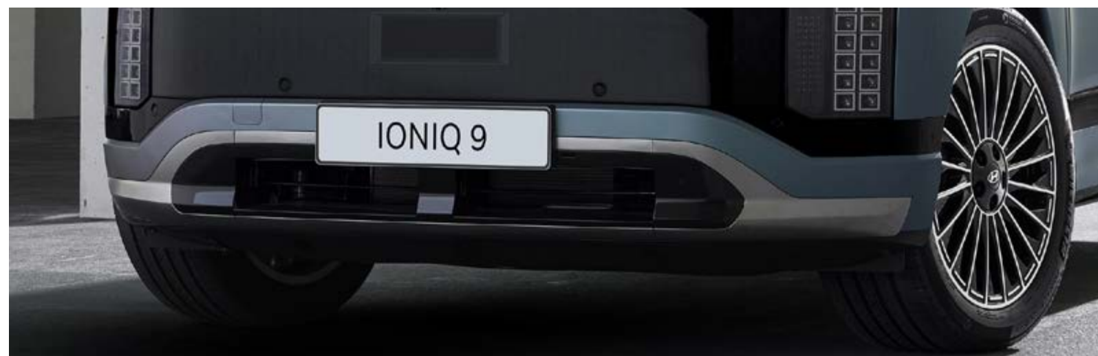
Systém aktivních vzduchových klapek pro lepší aerodynamiku a elegantnější vzhled
