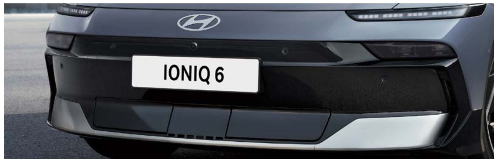
Aktivní vzduchové klapky se automaticky otevírají a zavírají pro maximální aerodynamickou účinnost a optimální chlazení trakčního akumulátoru
