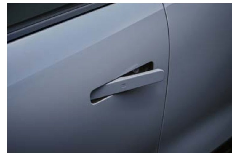
Zapuštěné kliky dveří s automatickým zasouváním
