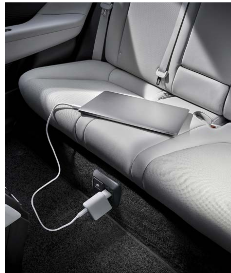
230V zásuvka V2L v interiéru
