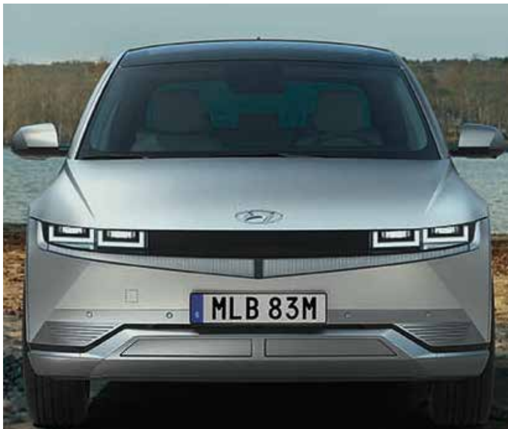
Främre stötfångare med aktivt luftintag
