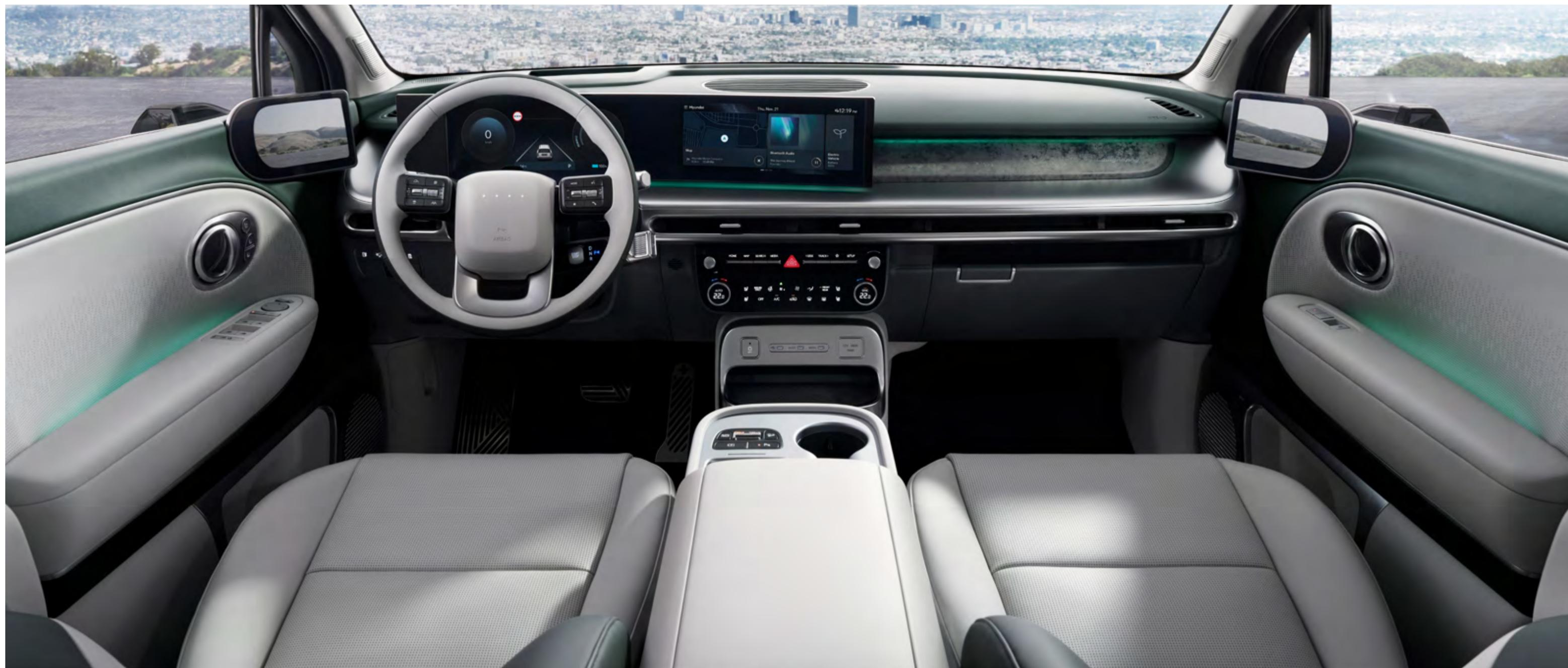
Unendo eleganza e minimalismo, lo schermo curvo integra sia il quadro strumenti digitale da 12.3" sia lo schermo dell'infotainment da 12.3". Il volante è dotato di quattro LED Parametric Pixel che le danno il benvenuto a bordo, indicano la modalità di guida e visualizzano lo stato di diversi sistemi del veicolo.
