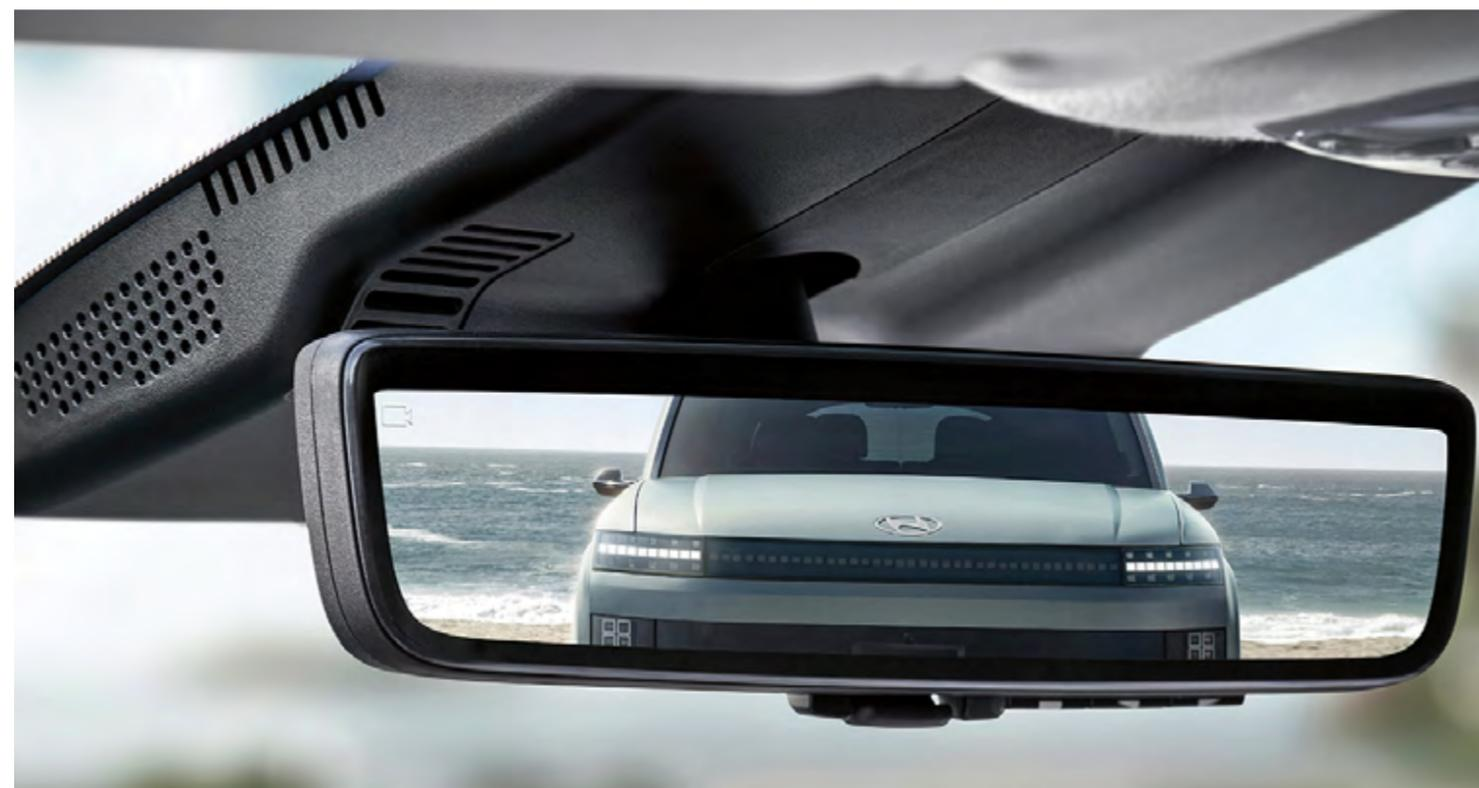
Quando lo specchietto retrovisore interno digitale è attivato, una telecamera montata nella parte posteriore trasmette un'immagine in diretta sullo schermo dello specchietto – offrendo così un campo visivo posteriore nettamente ampliato.
