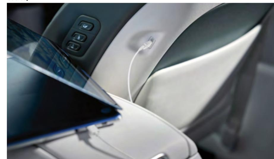
Porte USB-C nella seconda fila di sedili con funzione di ricarica rapida da 100 watt.
