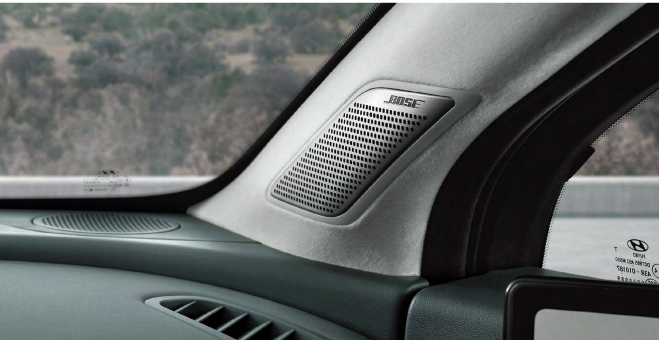
Sistema audio BOSE di alta gamma con 14 altoparlanti e tecnologia ANC-R.
