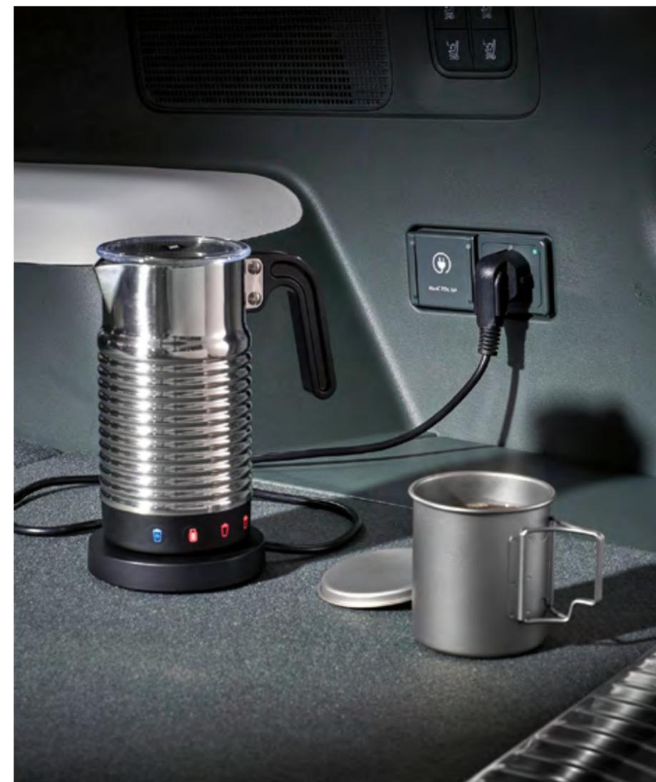
Presa da 230 V nel vano di carico – Vehicle-to-Load (V2L).
