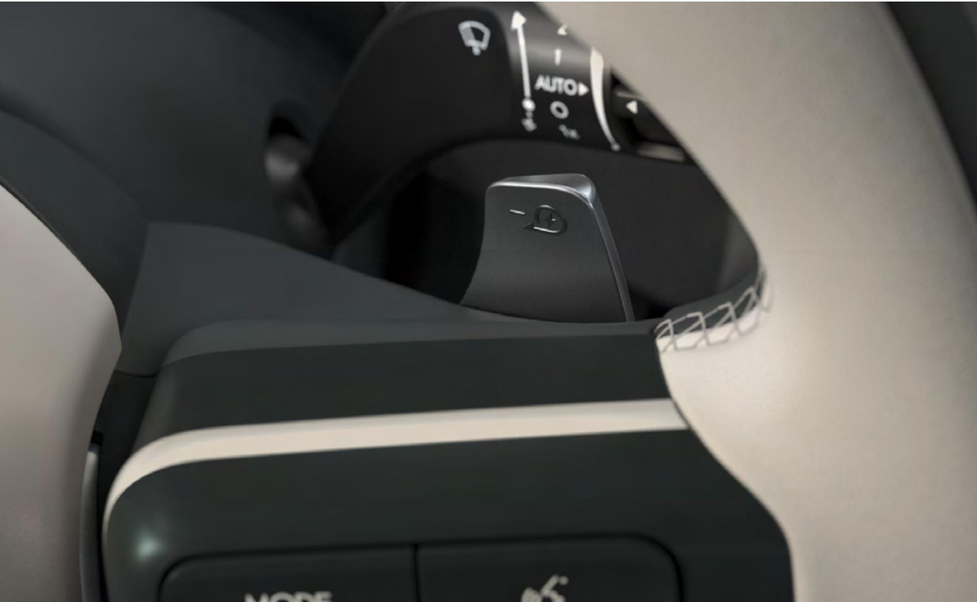
Il sistema di recupero dell'energia di IONIQ 9 ricarica la batteria durante la guida utilizzando il motore elettrico per rallentare il veicolo.
