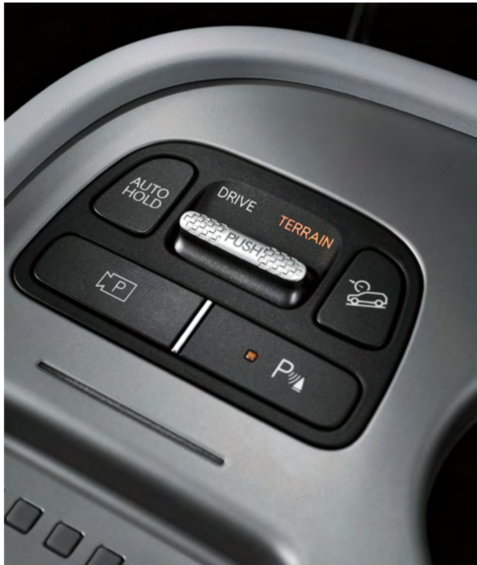
Mode Terrain à portée de main – avec les réglages Snow, Sand, Mud.
