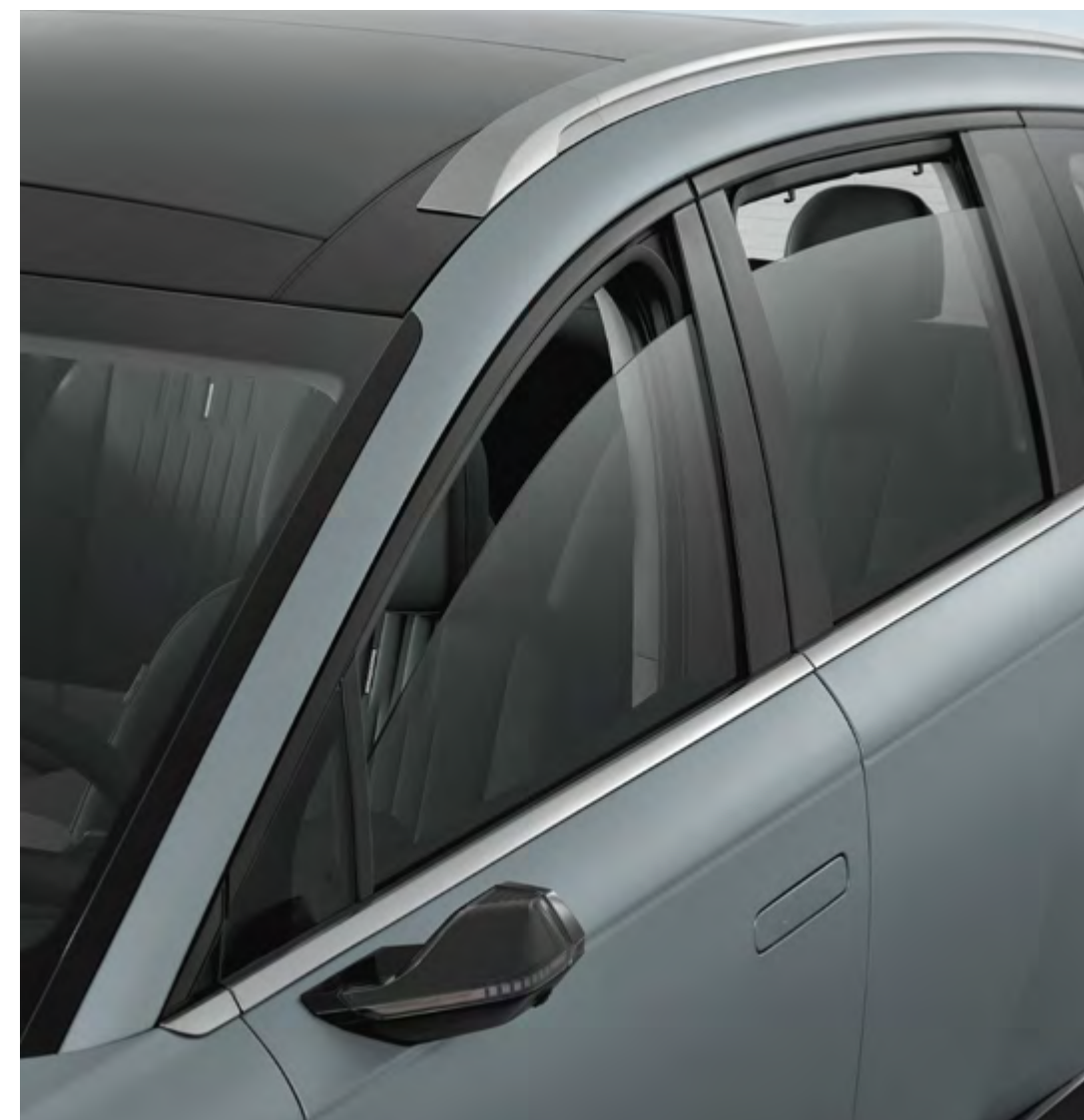
Vitrage acoustique doublement laminé.
