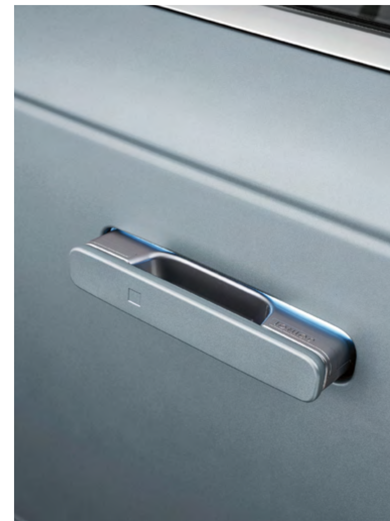
Poignées de porte à déploiement automatique.
