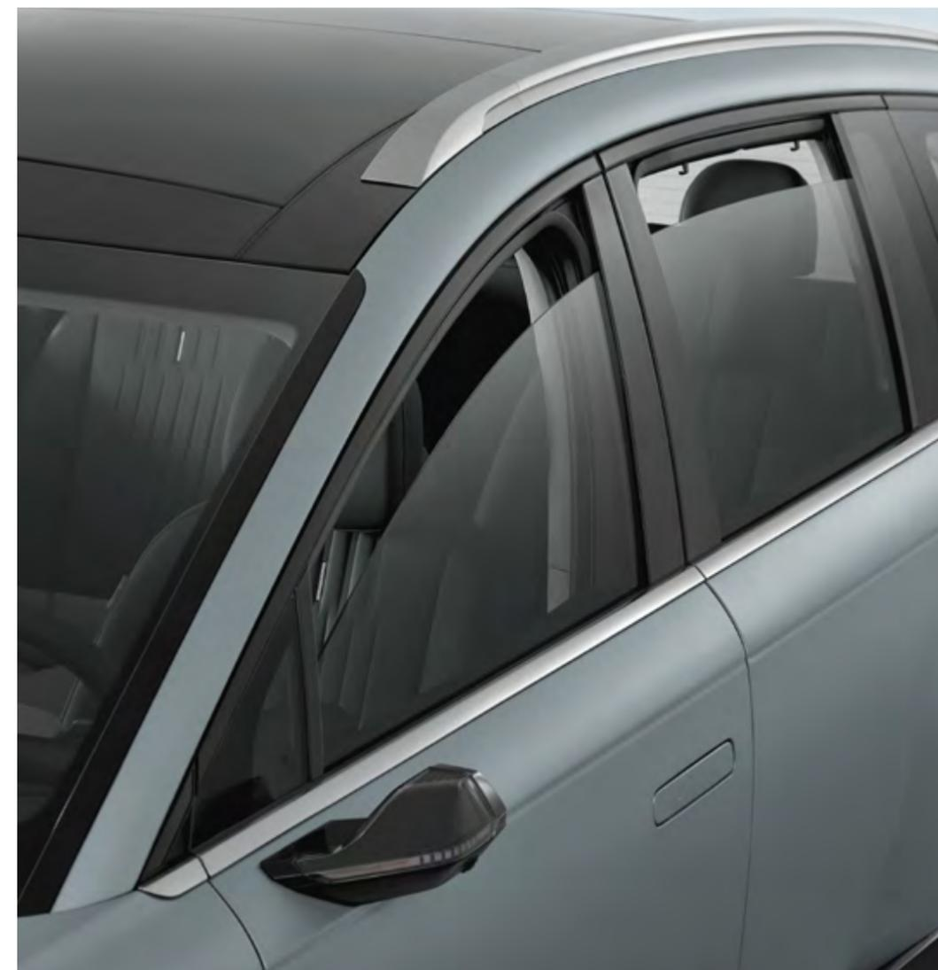
Doppelt laminiertes Schallschutzglas.
