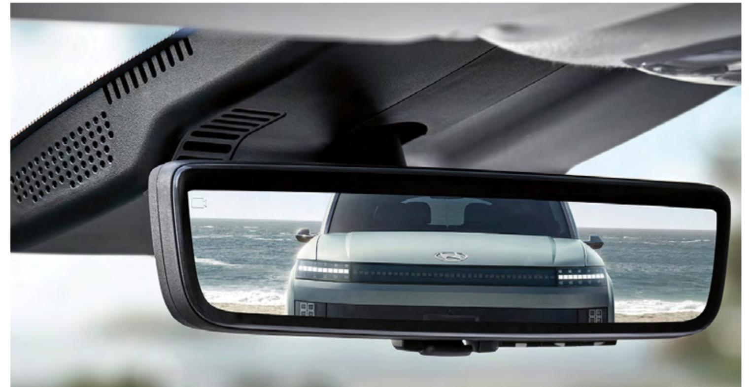
Wird der digitale Innenrückspiegel aktiviert, überträgt eine rückseitig montierte Kamera ein Livebild auf das Spiegeldisplay – für ein deutlich erweitertes Sichtfeld nach hinten.
