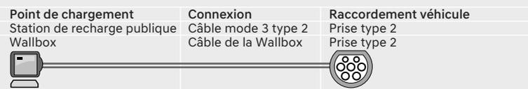
Relié à une borne de recharge à courant alternatif (AC), IONIQ 6 peut charger en triphasé à une puissance maximale de 11 kW, 16 ampères.
