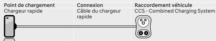
IONIQ 6 peut charger avec jusqu'à 220 kW de puissance sur une borne rapide en courant continu (DC). La vitesse de charge est maximale au démarrage, puis baisse progressivement. La charge au-delà de 80% est possible, cependant n'est plus optimale d'un point de vue durée et coût (le cas échéant). Pour optimiser la distance parcourue en un temps donné, il est souvent plus rapide d'arrêter la charge avant 80% afin de repartir plus tôt.
