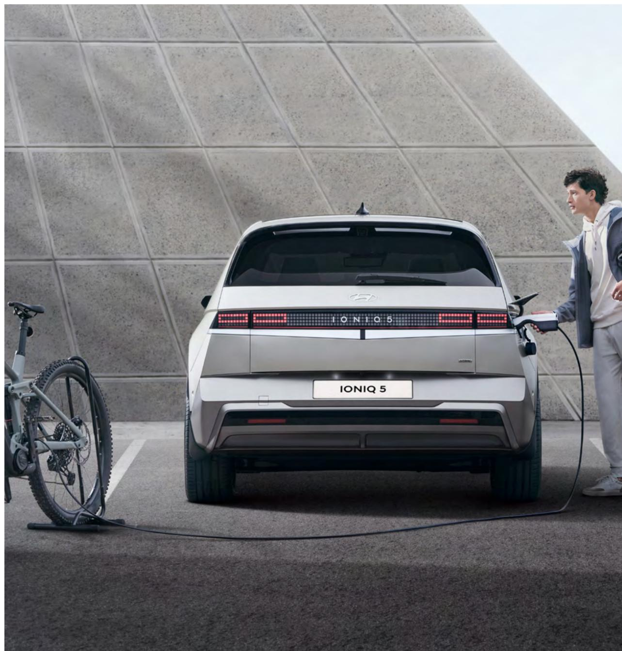
**Caricabatterie invertito (V2L) con adattatore per presa di ricarica esterna**
