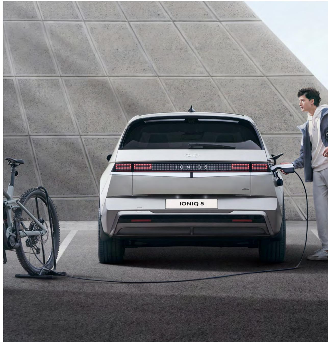
**Chargeur inversé (V2L) avec adaptateur pour prise de charge extérieure**
