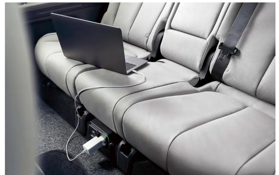
**Chargeur inversé (V2L) avec prise 220V sous les sièges arrière**
