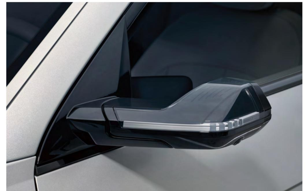
**Aerodynamischer digitaler Seitenspiegel (DSM)**
