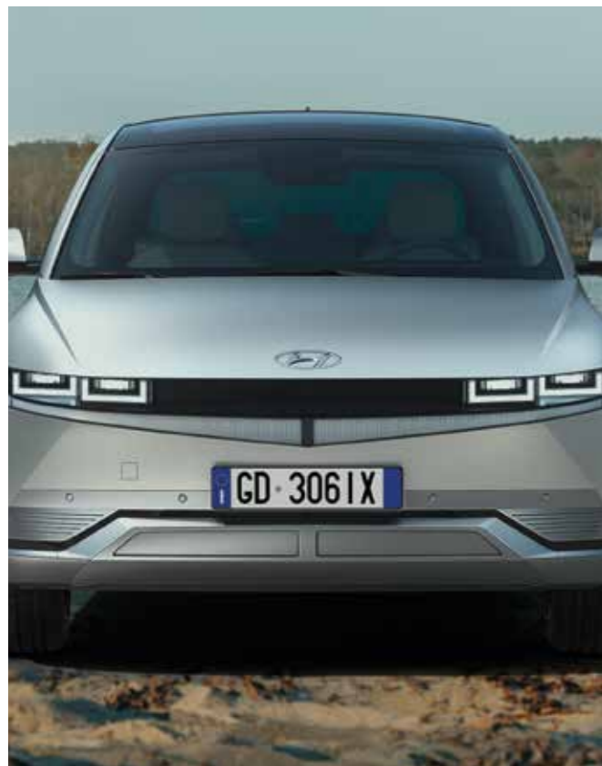
Paraurti anteriore con prese d'aria attive La forma a V pronunciata del paraurti anteriore enfatizza i fari a LED squadrati e dinamici. Le prese d'aria attive, integrate nella parte inferiore del paraurti, conferiscono un aspetto high tech alla parte anteriore della vettura, migliorando l'efficienza energetica quando chiuse e raffreddando, se necessario, i componenti interni del veicolo quando aperte.
