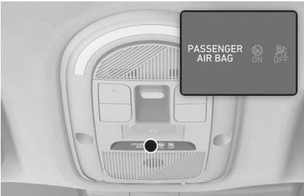
[A] Passasjerkollisjonspute PÅ [B] Passasjerkollisjonspute AV
