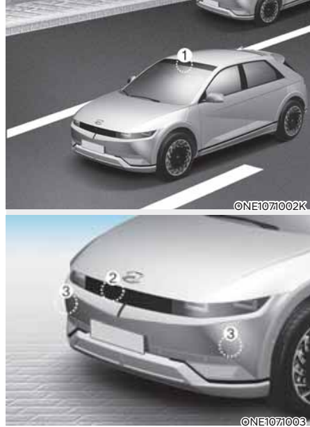
[1]: Ön görüş kamerası, [2]: Ön radar [3] : Ön köşe radarı
