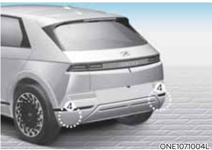
[1]: Ön görüş kamerası, [2]: Ön radar [3]: Ön köşe radarı (varsa), [4]: Arka köşe radarı (varsa)
