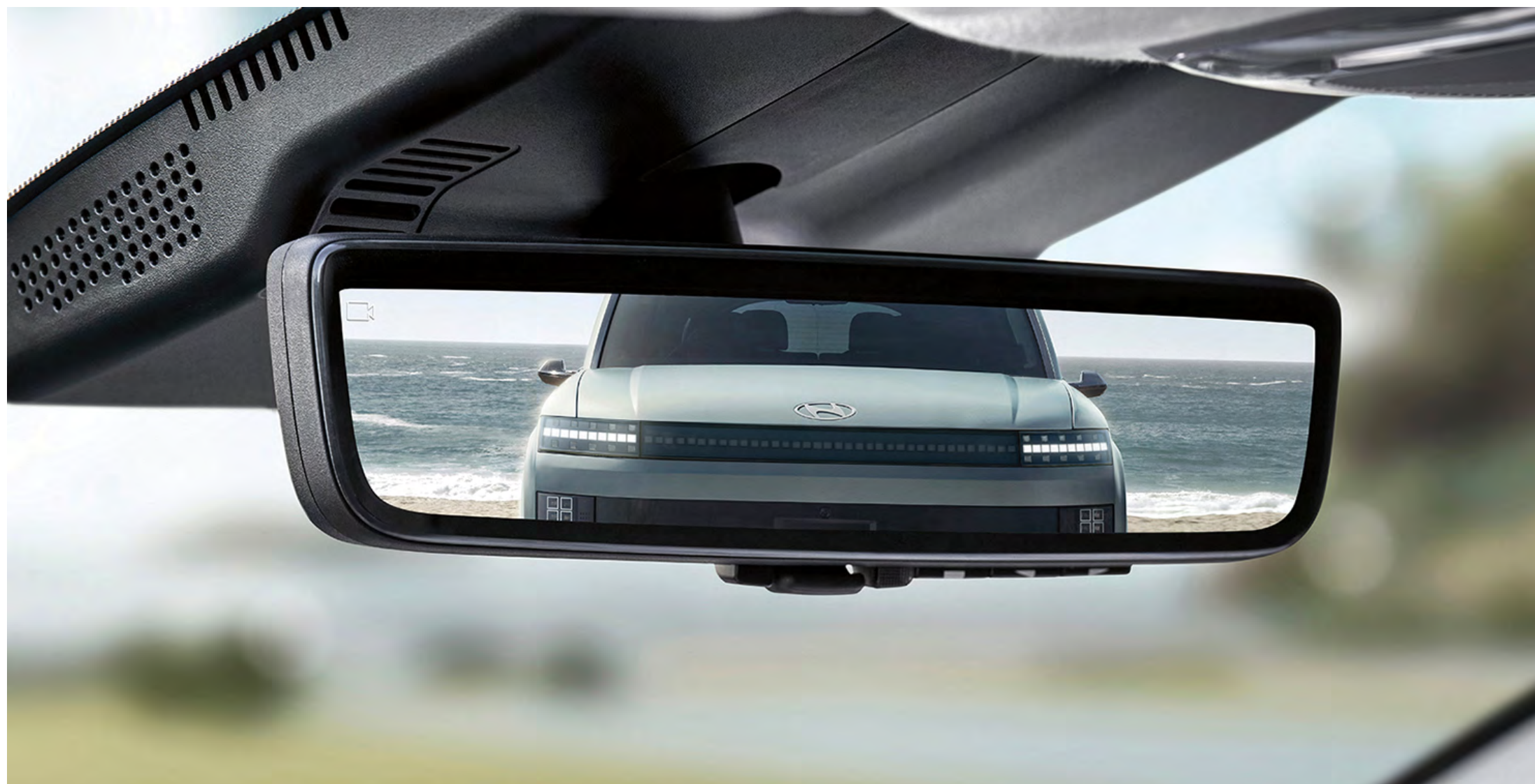
Bildet fra et kamera bak på bilen overføres i sanntid til det digitale speilet. Det gir et bredere bilde for bedre oversikt.
