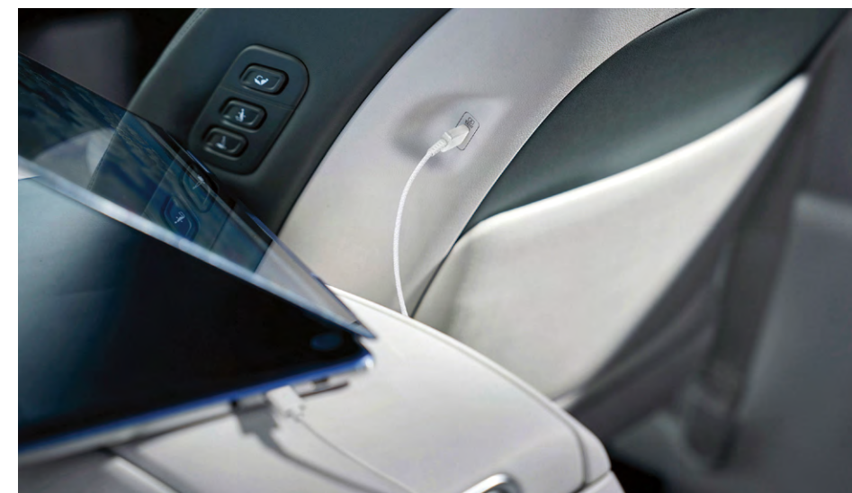
USB-C-porter med effekt på 100 watt på 2. seterad.
