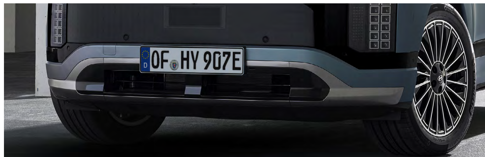
Aktive luftspjeld som minimerer luftmotstanden og gir et mer elegant utseende.
