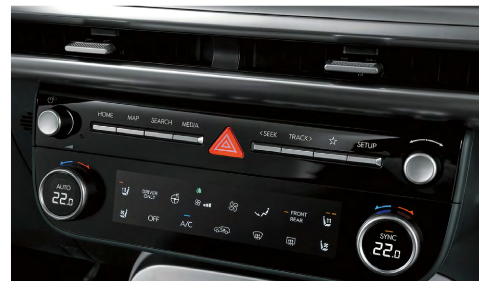
Smale luftdyser og automatisk tosoners klimaanlegg.
