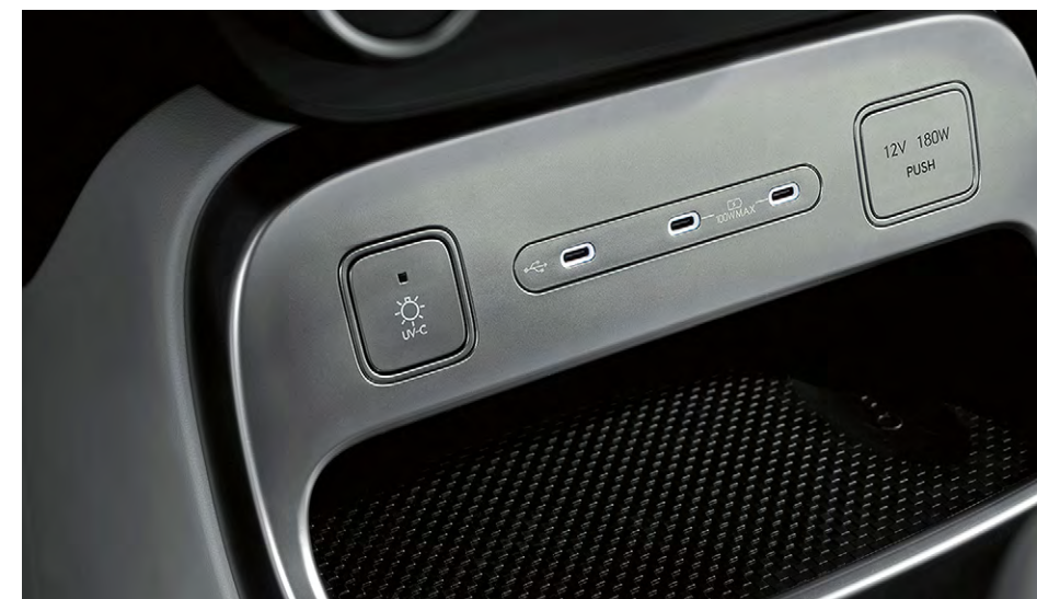
USB-C-porter med effekt på 100 watt på 1. seterad.
