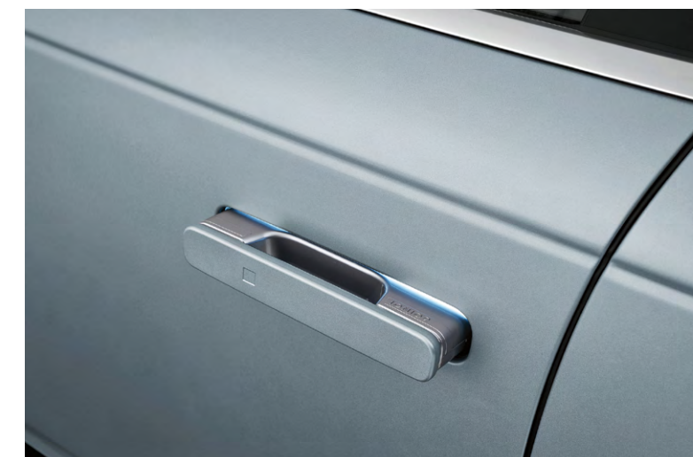
Automatiske, innfelte dørhåndtak.
