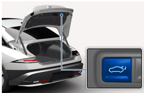
Inne i det elektriske bagasjerommet
