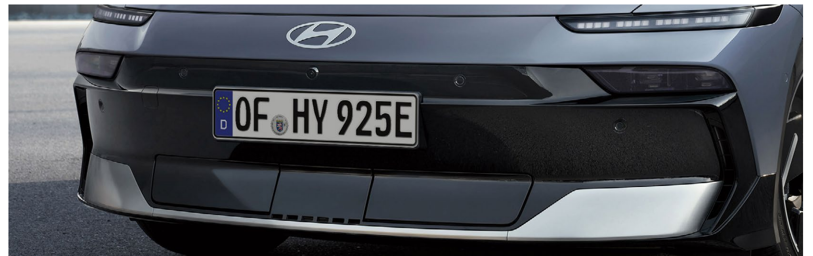
De aktive luftspjeldene åpnes og lukkes automatisk for best mulig aerodynamikk og kjøling av batteriet.
