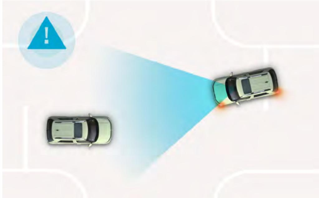
**Alerte de collision frontale avec fonction de virage (FCA-JT).**
