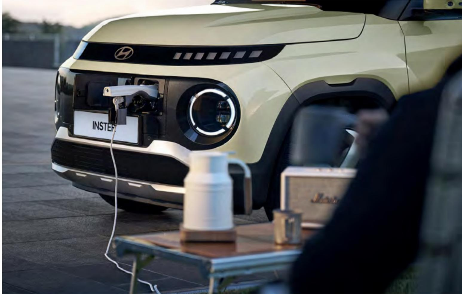
Branchez simplement votre ordinateur portable ou votre vélo électrique pour les recharger comme à la maison. Une prise 230V est située dans la console centrale et un adaptateur pour le port de charge externe fournit jusqu'à 3.6 kW de puissance – même lorsque le véhicule est éteint.
