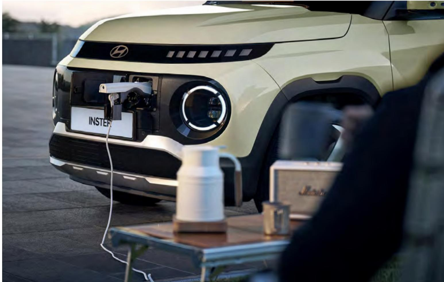
Schliessen Sie einfach Ihren Laptop oder Ihr E-Bike an, um sie wie zu Hause aufzuladen. Eine 230V-Steckdose befindet sich in der Mittelkonsole, und ein Adapter für den externen Ladeanschluss liefert bis zu 3.6 kW Leistung – selbst wenn das Fahrzeug ausgeschaltet ist.
