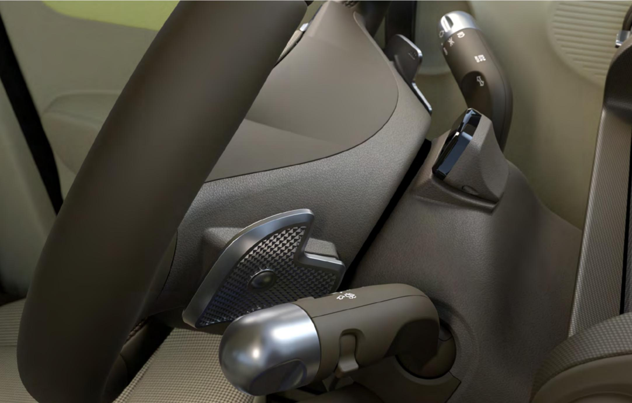
Das Rekuperationsbremssystem 2.0 des INSTER lädt die Batterie während der Fahrt, indem es den Elektromotor zur Verzögerung des Fahrzeugs nutzt. Sie können die Menge an Energie, die das System regeneriert und in der Batterie speichert, steuern, indem Sie die Rekuperation mit den am Lenkrad montierten Schaltwippen anpassen. Je höher das gewählte Niveau, desto stärker verlangsamt das Fahrzeug und lädt die Batterie, sobald Sie das Gaspedal loslassen.
