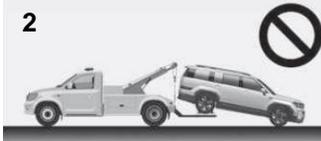
Avviso: non trainare con un'attrezzatura del tipo a imbracatura (1). Non trainare il veicolo con le ruote anteriori che toccano terra, poiché potrebbero verificarsi danni al veicolo (2).
