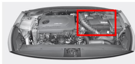
Batteria da 12 V nel vano motore
