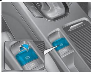
1. Bloccare le ruote e tirare l'interruttore **EPB** per inserire il freno di stazionamento.
