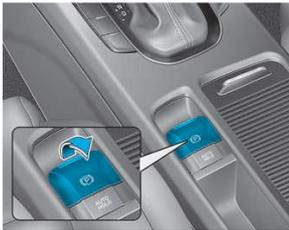
1. Verkeilen Sie die Räder und ziehen Sie den **EPB**-Schalter, um die Feststellbremse zu aktivieren.
