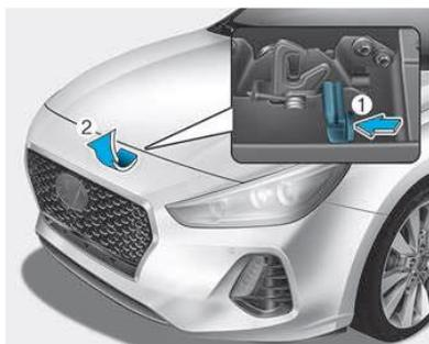
Levante ligeiramente o capot, empurre o trinco secundário para cima (1) no interior do centro do capot e abra o capot (2).
