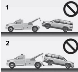
Avviso: non trainare con un'attrezzatura del tipo a imbracatura (1). Non trainare il veicolo con le ruote anteriori che toccano terra, poiché potrebbero verificarsi danni al veicolo (2).
