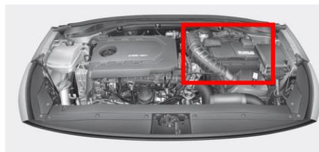
Batteria da 12 V nel vano motore
