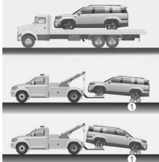
Avviso: si consiglia l'uso di carrelli con ruote (1) o pianale. Utilizzare un sollevatore delle ruote o un'attrezzatura a pianale.
