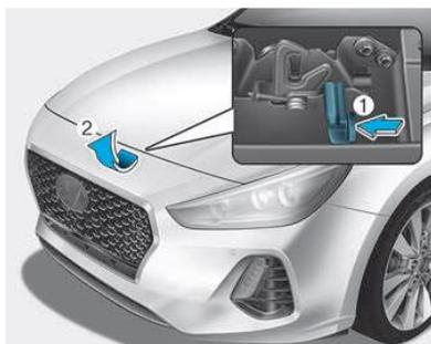
Levante ligeiramente o capot, empurre o trinco secundário para cima (1) no interior do centro do capot e abra o capot (2).
