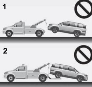
Advertência: não reboque com equipamento tipo eslinga (1). Não reboque o veículo com as rodas dianteiras no chão, uma vez que isso pode causar danos no veículo (2).
